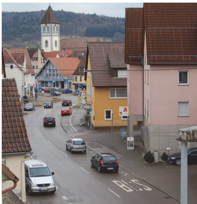
Bilder 3 und 4 | Vorher-Situation in Ortsmitte: Die überdimensionierte Fahrbahn, in Teilabschnitten beidseitig angeordnetes Parken und eine Vielfalt von Verkehrszeichen, Markierungen, Wegweisungsschildern dominieren das Straßenbild, freies Überqueren ist gefährlich, Zufußgehende sind an den Rand gedrängt, Aufenthaltsnutzungen finden kaum Platz
