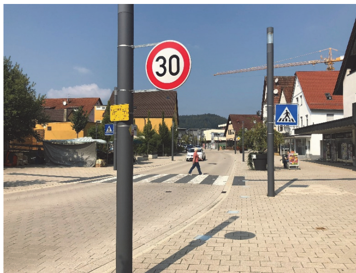
Bilder 21 bis 23 | Gesicherte Überquerungsstellen: ein Fußgängerüberweg (rechts) und eine Bedarfsampel (unten) ergänzen für unsichere und sehbeeinträchtigte Zufußgehende das Angebot, die „weich separierte“ Fahrbahn im gesamten Abschnitt frei zu überqueren
