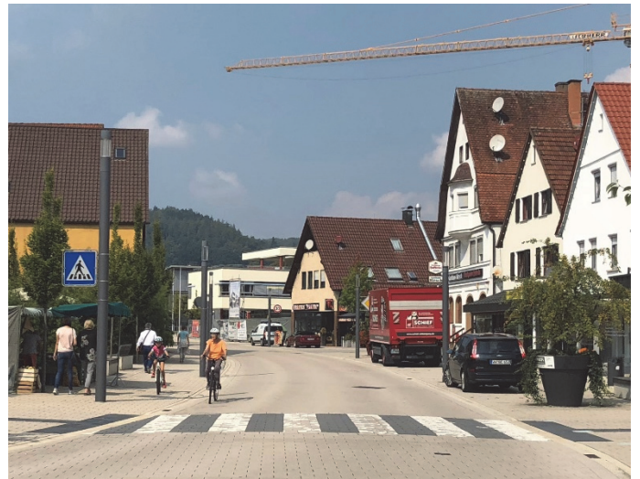
Bilder 24 und 25 | Radfahren auf der Fahrbahn: Das realisierte Gestaltungsprinzip und die angeordnete Geschwindigkeitsbeschränkung auf 30 km/h bieten zusammenwirkend Radfahrenden im Mischverkehr auf der Fahrbahn ausreichende Sicherheit, hauptsächlich Kinder fahren hier heute noch im Seitenraum
